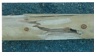
丸棒の実大引張試験
