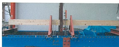
重ね梁の実大曲げ実験
