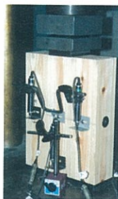
接合部の剪断実験
